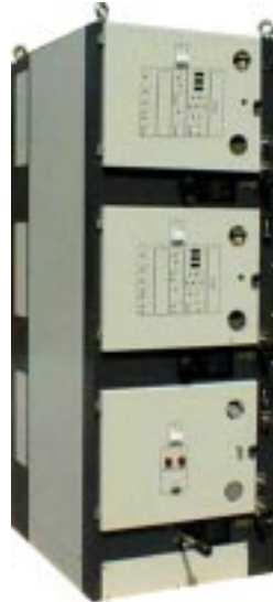
Cellules modulaires compactes de contrôle et de commande HTI . Haute sécurité d'exploitation par double sectionnement avec coupure visible, et fonctions multiples spécifiques . Départs contacteurs type EP10 - EP11.
